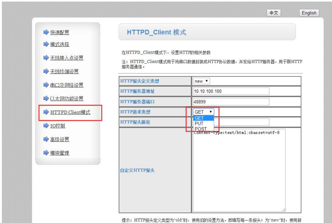
图 15 HTTPD Client 工作方式设置
