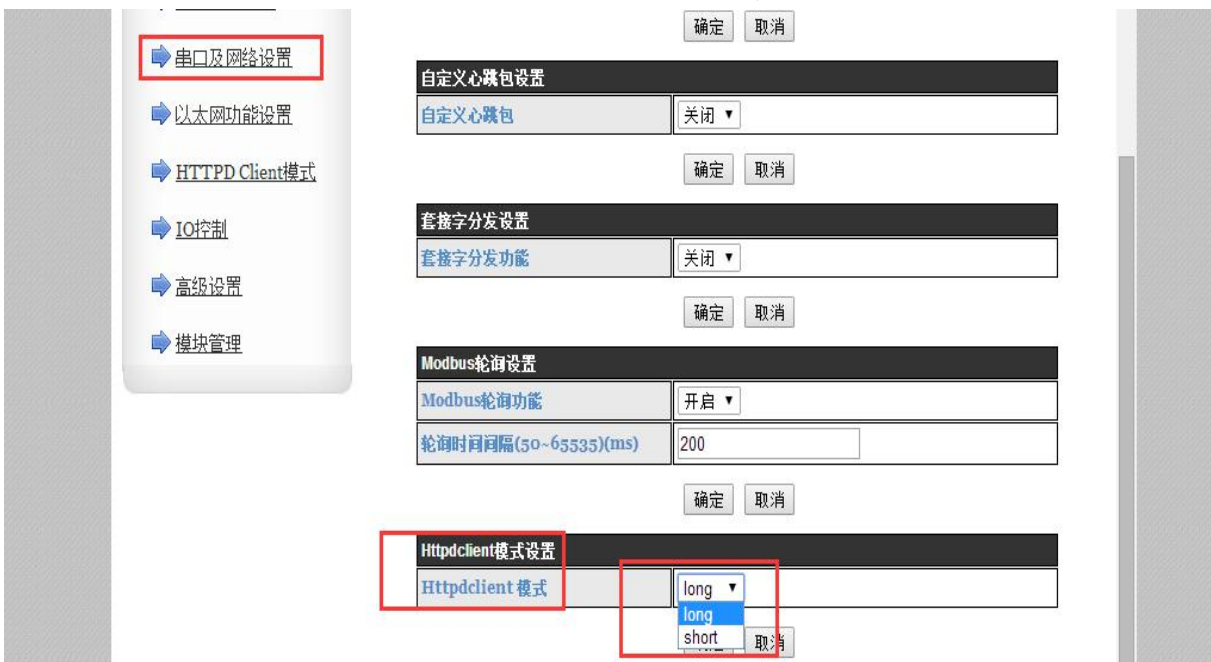
图 13 HTTPD Client 短连接
