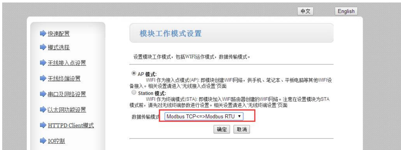
图 17 MODBUS TCP \leftrightarrow MODBUS RTU 模式选择
