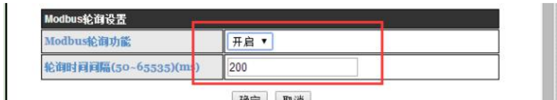
图 28 Modbus 轮询网页设置截图
