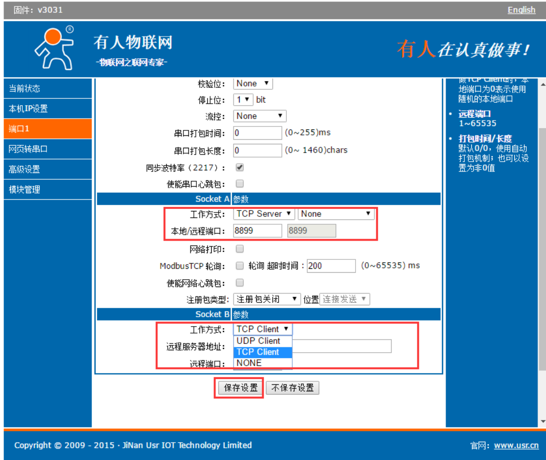
图6 Socket A/SocketB 设置方法
